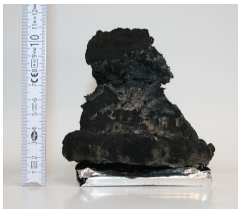
Wygląd silnie spęczniałej warstwy izolacyjnej powstałej na tworzywie po badaniu palności oraz zdjęcie wykonane za pomocą mikroskopu SEM obrazujące mikrostrukturę wewnątrz warstwy
