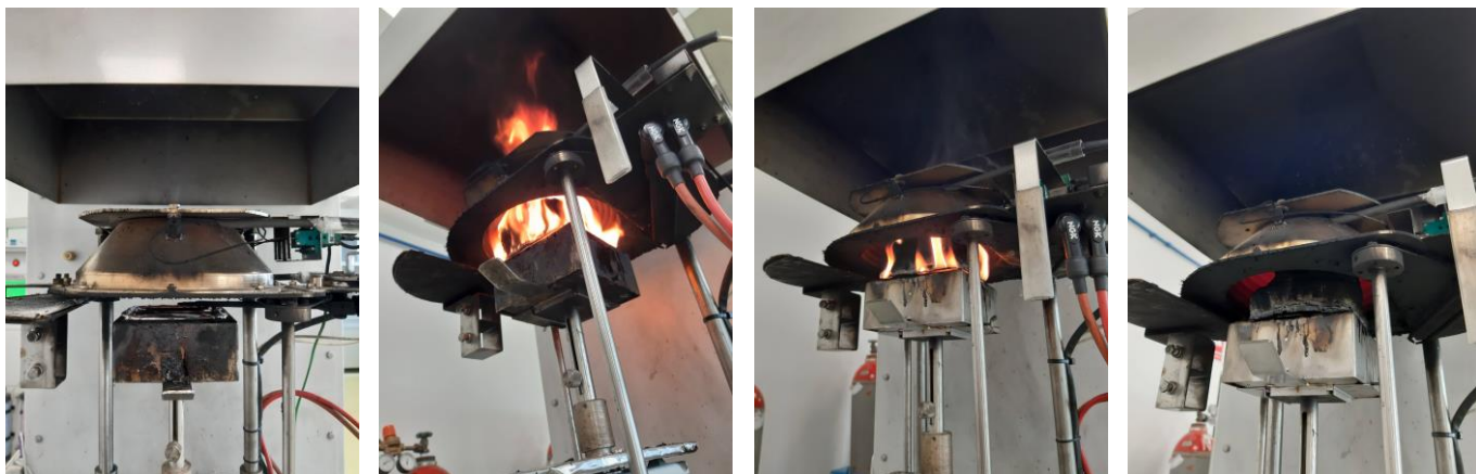
Przebieg badania palności obrazującego powstawanie warstwy izolującej, przeprowadzonego dla żywicy zawierającej opracowany ekologiczny układ uniepalniający
